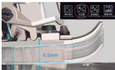
Regulagem eletrônica do calcador (13 estágios)
