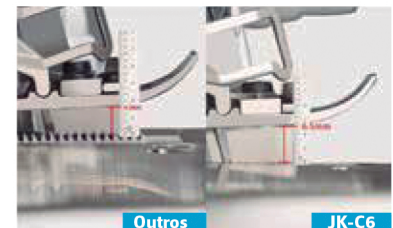
Altura do calcador com maior espaço de trabalho
