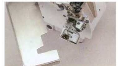
Preparada para instalação de dispositivos para elástico
