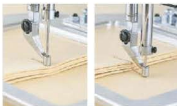
Calcador auxiliar com ajuste de altura
